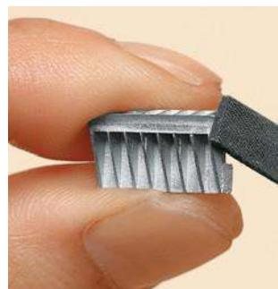
**12** Аналогично с шагом 8, сгладьте поверхность детали мелкозернистой наждачной бумагой. При обработке мелких участков, склоните края бумаги под углом, как показано на снимке
