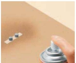
**77** После того, как проправа высохнет, с помощью аэрозольного баллончика распылите на поверхность узлов тонкий слой серой краски
