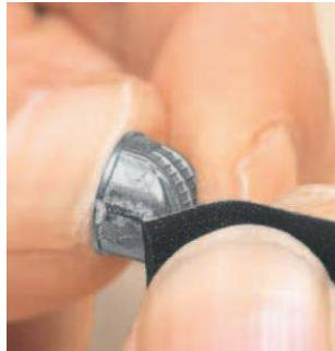
**58** На тех участках, где трудно получить необходимый результат с помощью наждачной бумаги, используйте лезвие канцелярского ножа. Также, ножом рекомендуется обработать кромки узла
