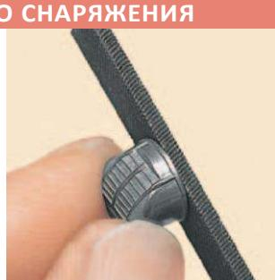
**57** После работы надфилем, складьте поверхность узлов оружейного снаряжения мелкозернистой наждачной бумагой (№ 800)
