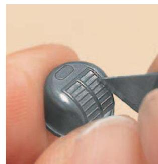
**59** Неровности на поверхности можно выровнять с помощью шпатлевки. После ее просушки, не забудьте складить поверхность наждачной бумагой
